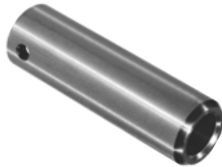
830.600 = PINO DO PATIM DO FREIO VOLVO DIANTEIRO (30 X 18 X 100) CEMENTADO N°. ORIG. (1.584.672)
