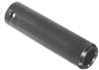
830.601 = PINO DO PATIM DO FREIO VOLVO TRASEIRO (30 X 18 X 115) CEMENTADO N°. ORIG. (1.586.716)
