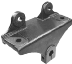
695.520 = SUPORTE DA MOLA DIANT. P/ DIANT. 17.210 A 26.310 E ÔNIBUS 16.210 / 17.210 Nº. ORIG. (2TJ-803.461)
