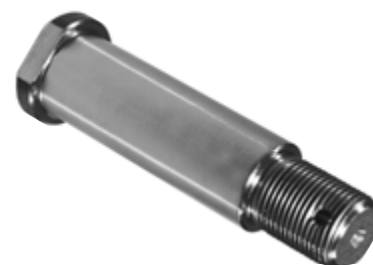
830.506 = PINO DO PATIM DO FREIO A AR MB ADAPTAÇÃO (38,1 X 30 X 126) (TODOS)
