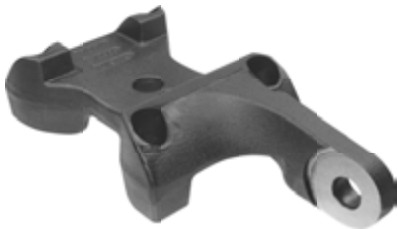
695.516 = SUPORTE DO AMORTEC. 18.310 SUSP. PNEUMÁTICA ESQ. Nº. ORIG. (2TO-511.149-A)
