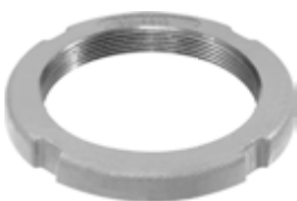
967.401 = PORCA DO EIXO CARRETA KRONE (90 X 120 X 15) ROSCA 12 FIOS GG40 FUNDIDO
