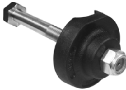
345.310 = CALÇO P/ LEVANTAR SUSPENSÃO DIANTEIRA F-4000
