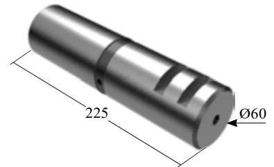
964.704 = PINO DA BALANÇÁ TRUCK RANON CH. TIPO "U" (60 X 225 MM) SAE 1045 964.705 = IDEM CEMENTADO
