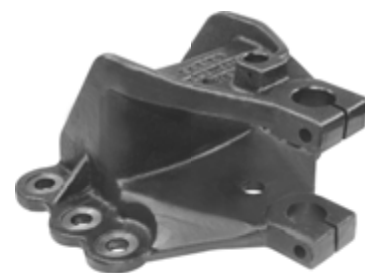
695.503 = SUPORTE DA MOLA TRAS. P/ DIANT. 16.170 A 24.250 ESQUERDO E ÔNIBUS 1618 N° ORIG. (TJG-803.571)
