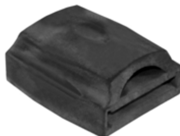
069.100 = APOIO DA PONTA DA MOLA TRASEIRO SPRINTER FURGÃO / PASSAGEIROS N° ORIG. (A901.325.0744)
