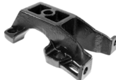
983.820 = SAPATA DO EIXO REDONDO CARRETA ROSSETTI (AÇO)
